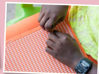
Plantilla de plástico con cuadros sobre la que se monta el papel para escribir con la regleta.
